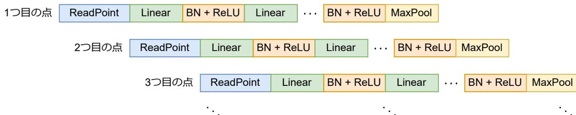
例えば、1つ目の点に対して、最後の全結合層を計算している間に、2つ目の点に対して、その一つ前のバッチ正規化層を計算するというように、複数の点に対する処理を時間的にオーバーラップさせます。以前は、ループ内の処理をパイプライン化して、ループの複数のイテレーションを並列に実行しました。そして、パイプラインの各ステージは、主に乗算や加算でした。ここでは、各ステージは一つの関数(タスク)に対応するので、より粗粒度なパイプライン化といえます。このようなタスクレベルのパイプライン化は、Vitis HLSでは**データフロー最適化 (Dataflow optimization)**とよばれています(**最適化その6: データフロー最適化**)。データフロー最適化を適用するには、いろいろな条件がありますが、今回の場合は大丈夫です。
