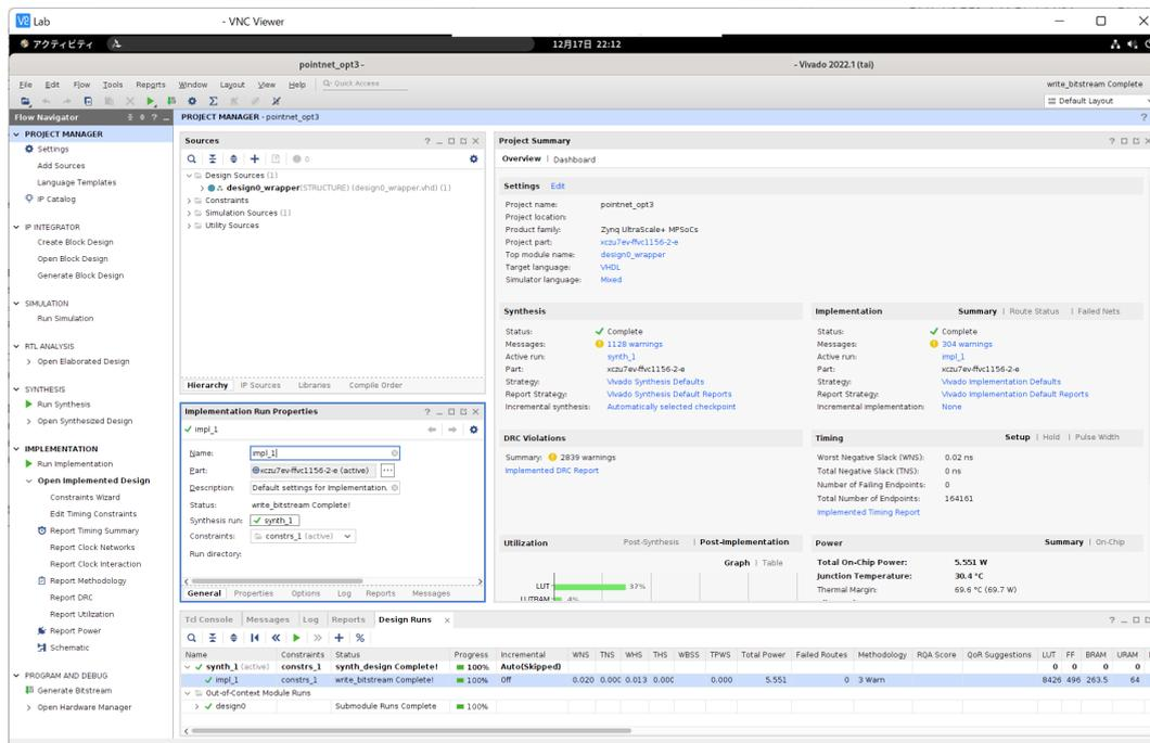
左側のFlow Navigatorから、「Open Block Design」を選択すると、ブロック図を表示できます。
