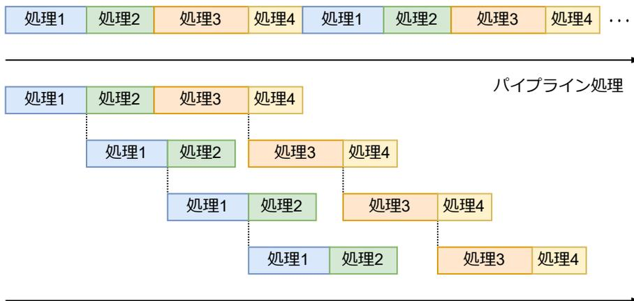
ループをパイプライン化しない場合は、ループの各イテレーションを順に実行します(図の上部)。一方、パイプライン化では、ループ内部の処理を分割(図の場合は4分割)し、それぞれの処理を時間的にオーバーラップさせます(図の下部)。複数のイテレーションを同時に実行するので、ループの実行時間を短縮できます。ループの実行時間は、最も時間の掛かる処理(図の場合は処理3)によって決まります。イテレーション
