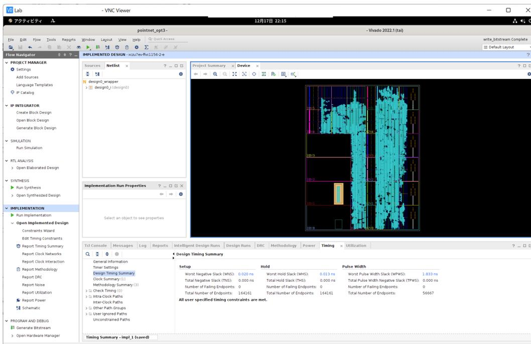
vivado/bitstreamディレクトリ以下に、生成されたビットストリームがコピーされます。ビットストリーム(拡張子.bit)の他に、Hardware Handoffファイル(拡張子.hwh)もあります。Handoffファイルには、回路のメタデータが含まれます。FPGAボードにビットストリームをロードするためには、2つのファイルがセットで必要になります。ビットストリームを読み直せば、動かす回路を何度でも切り替えられるというのが、ASICに対するFPGAの大きな利点です。さて、これらのファイルをscpなどでFPGAボード上に転送すれば、回路を動かす準備が整います。
