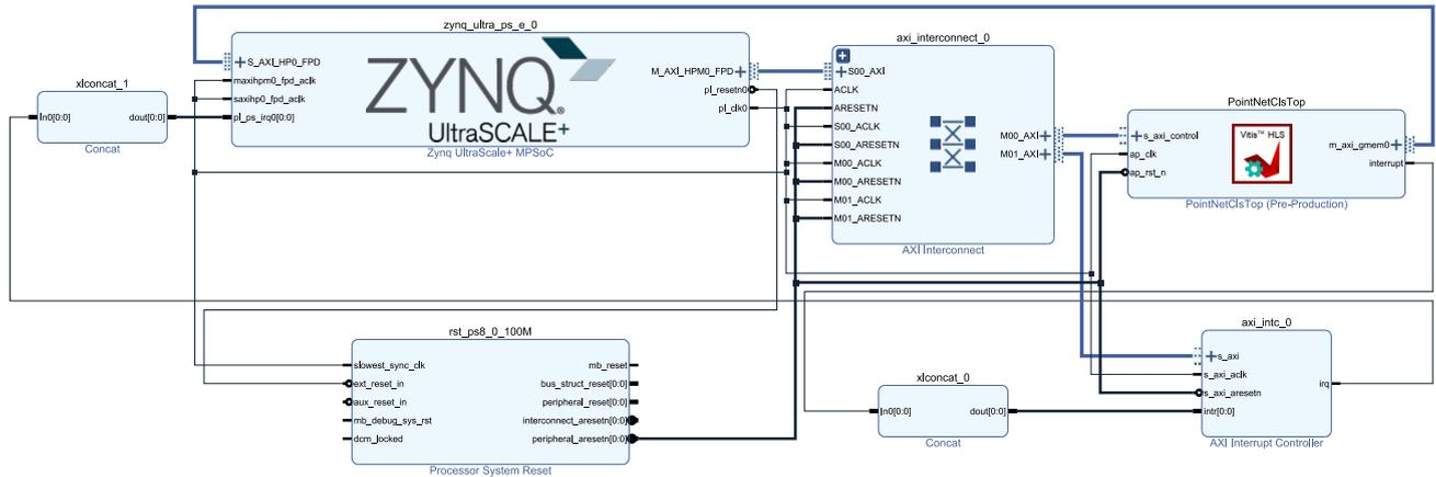
このブロックデザインに対して、論理合成および配置配線することで、回路情報を表すビットストリーム (Bitstream) を生成します。ビットストリームをFPGAにロードすることで、PointNetの専用回路が使えるようになります。
